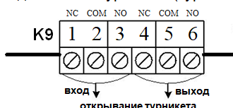
Пример 5. Подключение турникета (турникетный режим)
