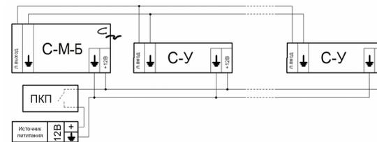
Рисунок – 3 Подключение оповещателей С-У к двум и более оповещателям С-М-Б
