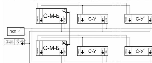
Рисунок – 4 Групповое подключение оповещателей С-У и С-М-Б с возможностью контроля управляющей и питающей линий с применением изделия БКЛО-12
