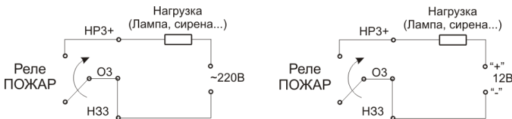
Рисунок 1 – Примеры подключения нагрузки к реле ПОЖАР
