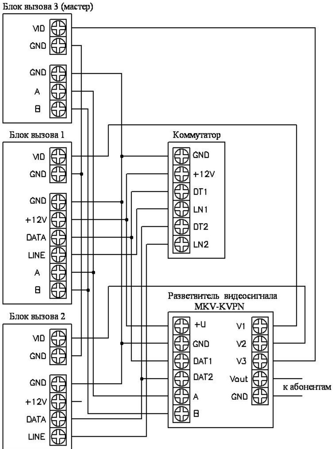
Рис. 1. Схема подключения разветвителя видеосигнала МЕТАКОМ MKV-KVPN.
