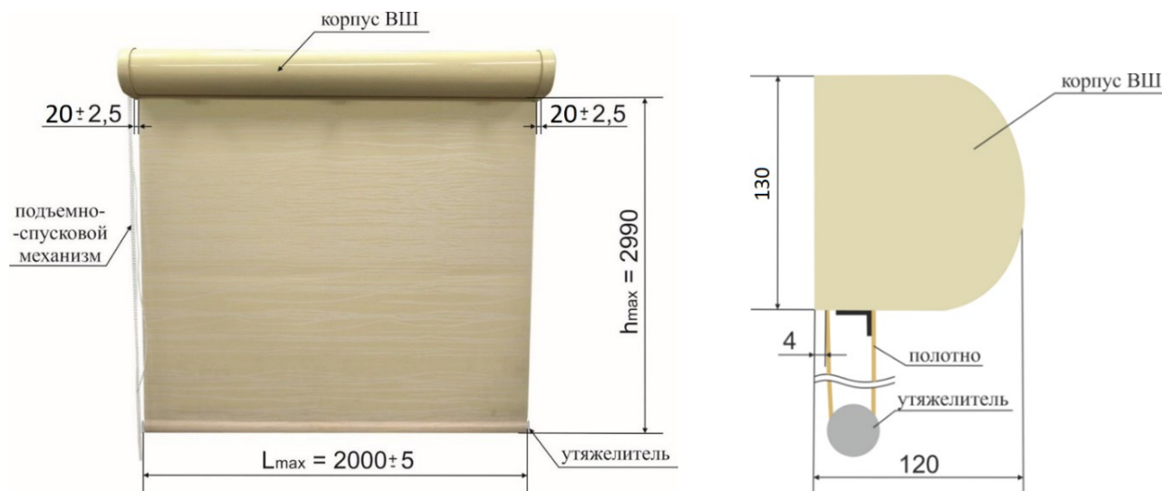
Рисунок 1 – Внешний вид ВШ-1/ВШ-2 /ВШ-2и (размеры указаны в мм)
