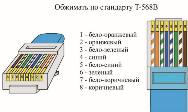
Рисунок 8 – Схема обжимки кабеля F/UTP (витая пара 4x2) штекером RJ-45 для подключения БГ к БУК и БГ к БГ
