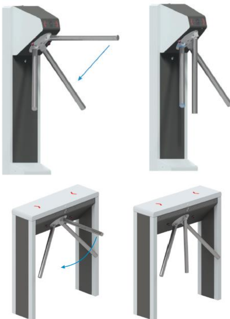
Рисунок 6.5.2 – Принцип работы автоматической системы разблокировки прохода
