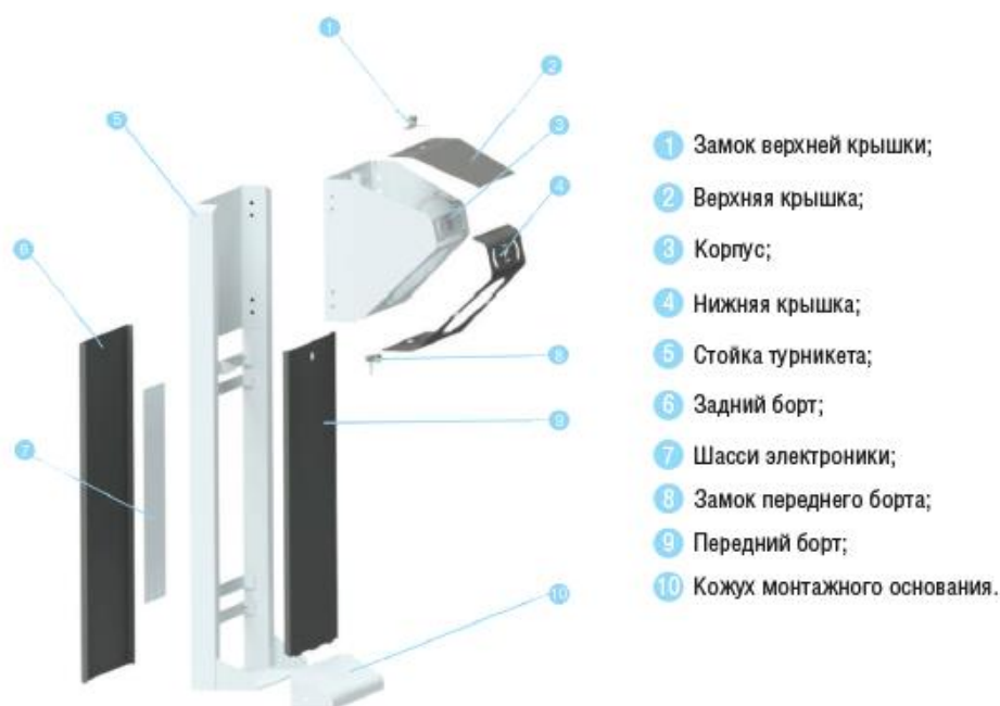
Рисунок 6.1.1. – Элементы корпуса турникета ЛКД ТТ-12-20
