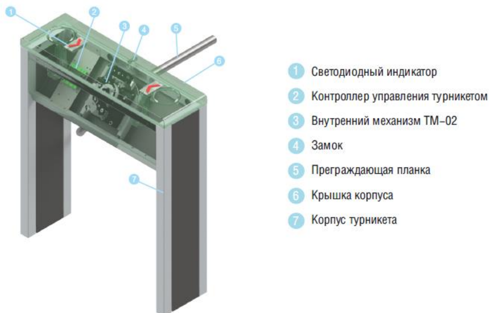
Рисунок 6.2 – Внешний вид турникета ЛКД ТТ-22-20.
