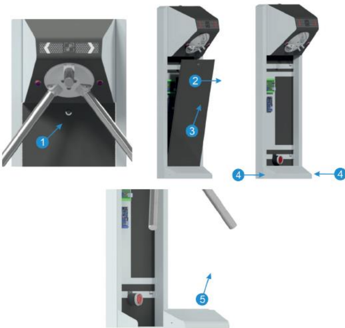
Рисунок 7.4.2 – Частичная разборка корпуса турникета ЛКД ТТ-12-20
