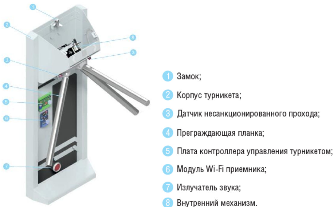
Рисунок 6.1. – Внешний вид турникета ЛКД ТТ-12-20.
