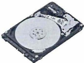
Жесткий магнитный диск - носитель данных в виде тонкого диска из немагнитного материала (обычно из алюминия, стекла или керамики), покрытого с одной или двух сторон слоем ферромагнетика. **Ферромагнетик** - вещество, способное намагничиваться, то есть под воздействием внешнего магнитного поля изменять уровень остаточной намагниченности. Это свойство используется для записи единиц информации (упрощенно 1 – намагничен, 0 – размагничен) на
