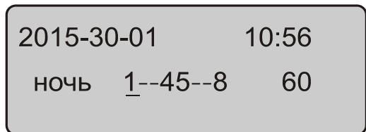
Как видно из представленного рисунка, разрешены для сканирования камеры 1,4,5 и 8, камеры 2,3 и 7 запрещены. Такая конфигурация задается в режиме программирования – подпункт меню 2.05. Параметр 60 – это время отображения активных камер при их автоматической смене, задаётся в режиме программирования подпункт 2.06.
