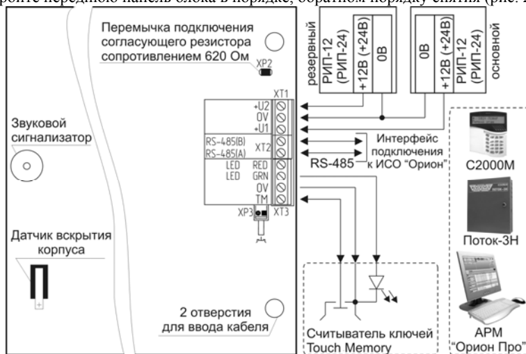
Рисунок 3. Схема внешних соединений блока «Поток-БКИ»
