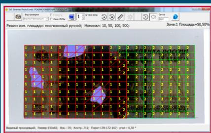
Данный режим позволяет эксперту измерять площадь склеенной банкноты, состоящей из разных фрагментов других банкнот, не производя расклейку. Выбрав подходящий режим осветителей, можно вручную подсчитать площадь каждого фрагмента банкноты (либо площадь каждой зоны) по отдельности.
