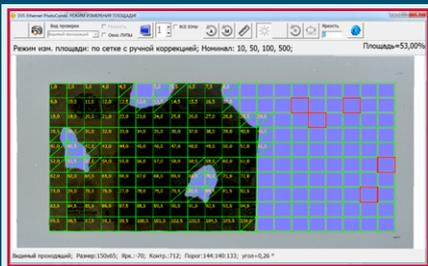
В данном режиме программа автоматически накладывает сетку из 200 клеток и выполняет подсчет клеток с выводом результатов измерения. Точность вычислений в режиме измерения площади по сетке составляет 0,25% от размера эталонной банкноты.
