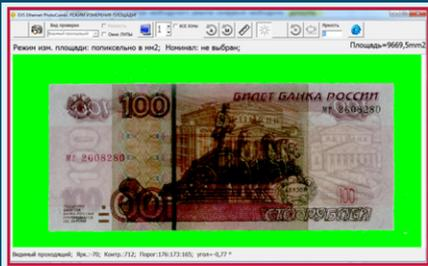
В данном режиме программа автоматически определяет границы банкноты и производит подсчет с точностью до одного пикселя, что составляет 0,005 мм<sup>2</sup>. Результат измерения выводится в мм<sup>2</sup> и в процентном соотношении к эталонному размеру банкноты.
